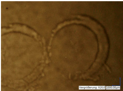
Figura 19b: Bordes de disolvente alrededor de una estructura de junta tórica (conforme con LABS), foto con luz incidente
