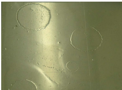
Figura 23: Bordes de disolvente recubiertos de pintura (ningún defecto por LABS)
