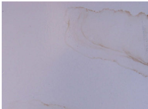
Figura 20: Sangrado debido a un residuo oleaginoso sobre el sustrato de prueba (ningún defecto por LABS).
