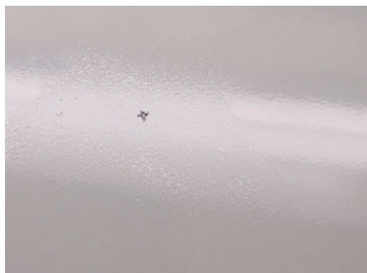
Figura 22: Película de aceite recubierta de pintura y demasiado gruesa (ningún defecto por LABS) / NOTA: en el centro se aprecia una marca del enfoque de la cámara.
