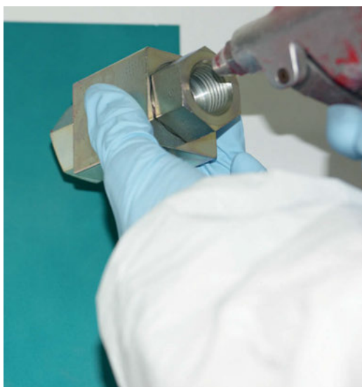
Figura 7: Soplado de una superficie interior sobre el sustrato de prueba
