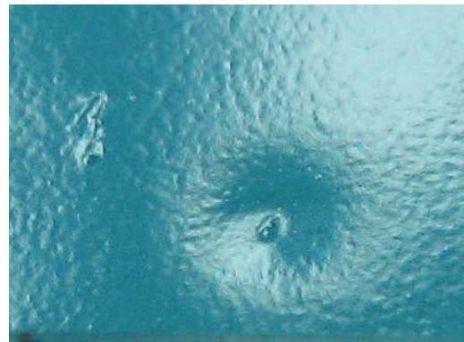
Figura 11: Cráter (defecto de LABS)
