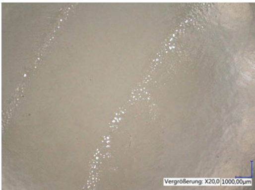
Figura 16a: Defecto de LABS causado por sustancias que afectan la pintura liberadas por una junta tórica, foto con luz incidente
