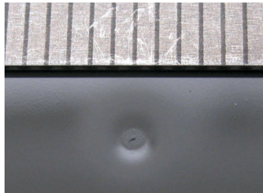
Figura 12: Cráter (defecto de LABS)
